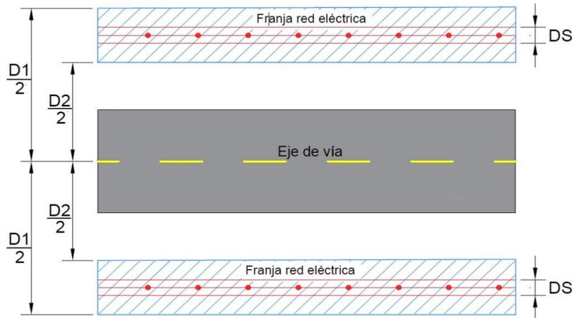
**Figura 8. Fajas de retiro para las vías de doble calzada.**
