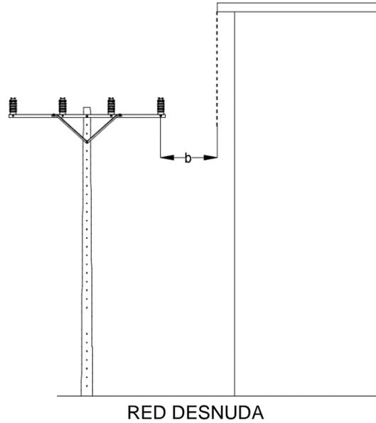
**Figura 4. Distancia horizontal entre la red eléctrica con conductores desnudos y la proyección del balcón de una edificación por encima de la red.**
