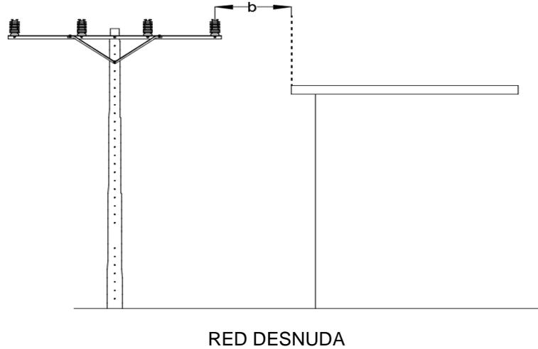
**Figura 2. Distancia horizontal entre la red eléctrica con conductores desnudos y la proyección del balcón de una edificación por debajo de la red.**
